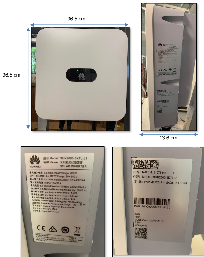
Fotografía 1. Fotografías y datos de placa del inversor.
