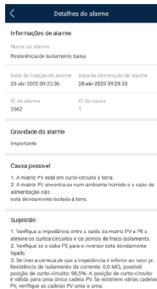
Figura E-1 Detalhes do alarme
