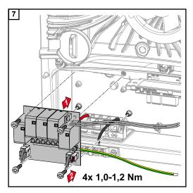
Insira o cartão no inversor e fixe com os 4 parafusos (TX20) fornecidos e um torque de 1,0 - 1,2 Nm.
