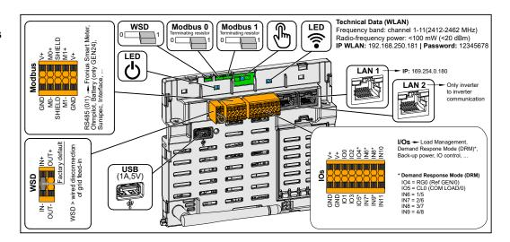
Borne de conexão Push-in para a instalação do Modbus 0, Modbus 1, 12 V e GND (terra).
