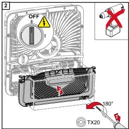
Certifique-se de que o disjuntor CC esteja com o interruptor na posição "Desligado". Solte os cinco parafusos da tampa da área de conexão com uma chave de fenda (TX20) e uma rotação de 180° para a esquerda.
