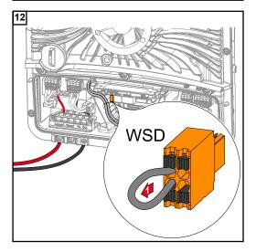
Remova a ponte instalada de fábrica no borne de conexão Push-in WSD.
