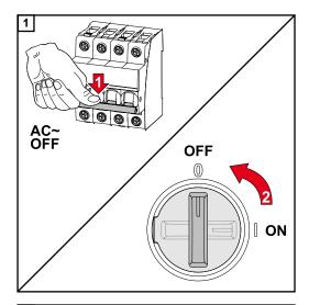
Desligue o disjuntor. Coloque o disjuntor CC na posição "Desligada" do interruptor.
