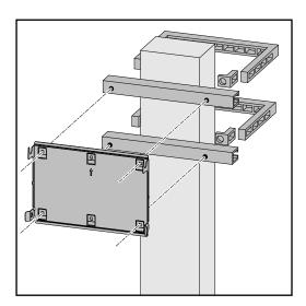
Ao montar o inversor em um mastro ou suporte, a Fronius recomenda o conjunto de montagem "Pole clamp" (nº do pedido SZ 2584.000) da Rittal GmbH.
