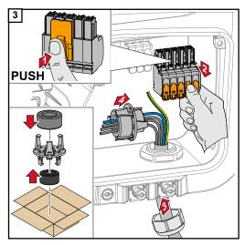
Apertar o encaixe na traseira do borne de conexão e retirar o borne de conexão CA. Passar o cabo de energia por baixo pelo alívio de tensão do lado direito, no núcleo de ferrite.
