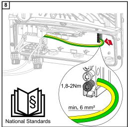
Prender o fio terra com seção transversal do cabo de, no mínimo, 6 mm², na primeira entrada de baixo no borne de conexão dos eletrodos de aterramento com uma chave de fenda (TX20) e um torque de 1,8 – 2 Nm.
