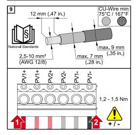
Decape 12 mm dos fios individuais e prenda na ranhura prevista no borne de conexão do cartão com um torque de 1,2 – 1,5 Nm.
