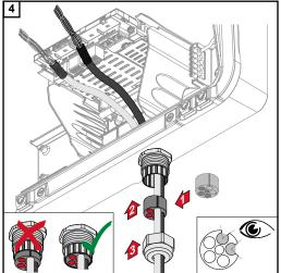
Insira o anel de vedação entre a porca de capa e a abertura da carcaça. Pressione os cabos de dados para dentro da condução de cabos da vedação. Em seguida, empurre a vedação para dentro até a borda inferior do alívio de tensão.
