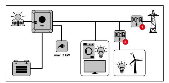
Modo de operação – Inversor com bateria, acoplado em CA a outro inversor
