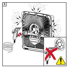
Remova os depósitos de sujeira no dissipador de calor e no ventilador com ar comprimido, pano ou pincel.
