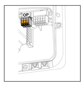
Com o PV Point, é possível alimentar equipamentos elétricos de fase única com uma corrente máxima de 3 kW no borne de conexão Opportunity Power (OP) caso ocorra uma falha da rede elétrica pública, desde que haja potência suficiente disponível dos módulos solares ou uma bateria opcional. Não há tensão no borne de conexão OP durante a operação acoplada à rede, por isso, as cargas conectadas não são fornecidas nessa operação.
