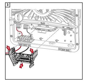
Remova a separação da área de conexão, acionando os ganchos de encaixe.
