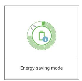
O modo de baixo consumo de energia é representado no site do inversor e no Solar.web por um "i" ao lado do símbolo da bateria na visão geral do sistema.
