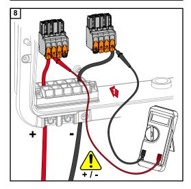
Verifique a tensão e a polaridade do cabeamento CC com um instrumento de medição adequado. Retire os dois bornes de conexão CC das ranhuras.
