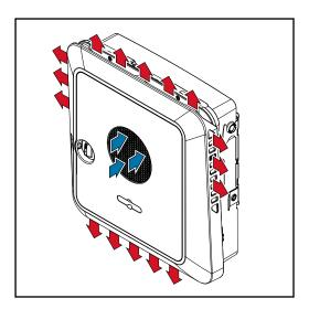
O ventilador frontal aspira o ar ambiente e o sopra para fora nas laterais do equipamento. A dissipação uniforme de calor permite a instalação de vários inversores lado a lado.
