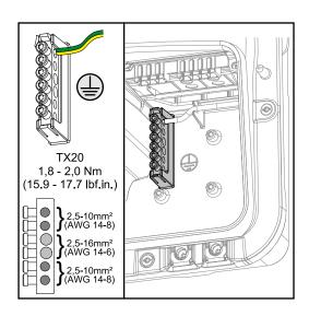
O borne de conexão do eletrodo de aterramento 🖶 oferece a possibilidade de aterrar outros componentes, por exemplo:
