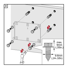
Instalar o suporte de montagem em um mastro ou em um suporte
