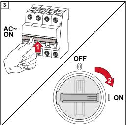
Ligue o disjuntor. Coloque o disjuntor CC na posição "Ligada" do interruptor.
