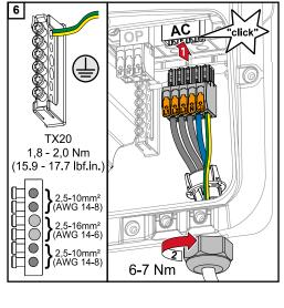
Insira o borne de conexão CA na ranhura CA até ele se encaixar. Aperte a porca de fixação do alívio de tensão com um torque de 6-7 Nm.
