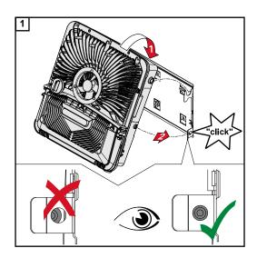
Encaixe o inversor no suporte de montagem por cima. As conexões devem apontar para baixo.
