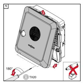
Desaperte os 2 parafusos na parte inferior da tampa da carcaça com uma chave de fenda (TX20) e uma rotação de 180° para a esquerda. Em seguida, levante a tampa da carcaça na parte inferior do inversor e remova da parte de cima.
