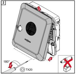
Desaperte os parafusos na parte inferior da tampa da carcaça com uma chave de fenda (TX20) e uma rotação de 180° para a esquerda. Em seguida, levante a tampa da carcaça na parte inferior do inversor e remova da parte de cima.
