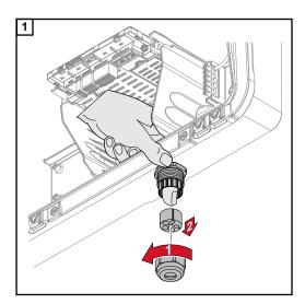
Solte a porca de capa do alívio de tensão e empurre para fora o anel de vedação com os tampões cegos da parte de dentro do equipamento.
