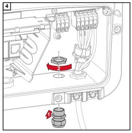
Insira o alívio de tensão no orifício e aperte-o com o torque especificado pelo fabricante.
