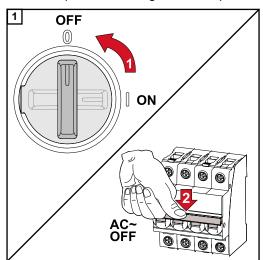
Coloque o disjuntor CC na posição "Desligada" do interruptor. Desligue o disjuntor.
