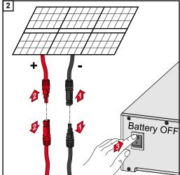
Soltar as conexões dos cabos do módulo solar (+/-). A bateria conectada no inversor é desligada.
