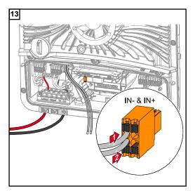
Conectar o cabo do sinal nas ranhuras INe IN+ observando as inscrições no borne de conexão Push-in WSD.
