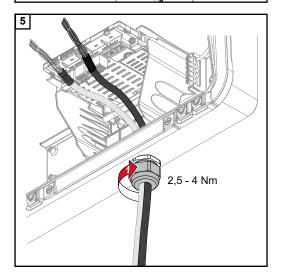
Aperte a porca de capa do alívio de tensão com um torque de 2,5 a 4 Nm.
