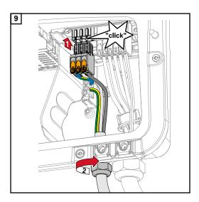
Insira o borne de conexão OP na ranhura OP até ele se encaixar. Aperte a porca de fixação do alívio de tensão com o torque especificado pelo fabricante.
