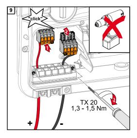
Insira os bornes de conexão CC na respectiva ranhura até que eles encaixem. Aperte os parafusos da condução de cabos com uma chave de fenda (TX20) e um torque de 1,3 – 1,5 Nm para fixar a carcaça.
