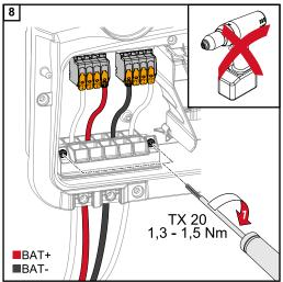
Aperte os parafusos da condução de cabos com uma chave de fenda (TX20) e um torque de 1,3 – 1,5 Nm para fixar a carcaça.
