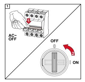
Desenergize o inversor e aguarde o tempo de descarga (2 minutos) dos capacitores e o tempo de inatividade do ventilador. Mude o disjuntor CC para a posição "Desligado".
