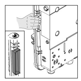
Na lateral do inversor existem alças integradas para facilitar a elevação/ suspensão.
