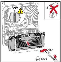
Solte os 5 parafusos da tampa da área de conexão com uma chave de fenda (TX20) e uma rotação de 180° para a esquerda. Remova a tampa da área de conexão do equipamento.
