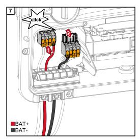
Insira os bornes de conexão CC na respectiva ranhura até que eles encaixem.
