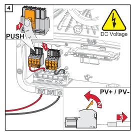
Remova os bornes de conexão Push-in CC das ranhuras e desconecte dos cabos (necessário apenas no caso de instalação já existente).
