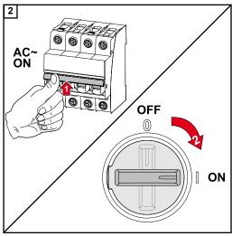
Ligue o disjuntor. Coloque o disjuntor CC na posição "Ligado" do interruptor.
