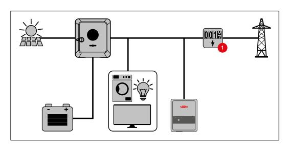
Modo de operação – Inversor com bateria e outro inversor
