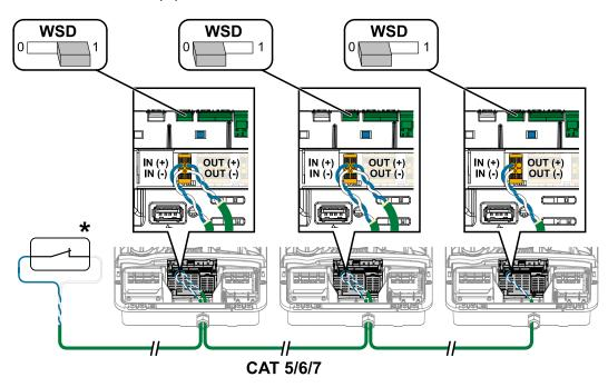
\*Contato sem potencial do dispositivo de gatilho (por exemplo, proteção NA central). Se vários contatos sem potencial forem utilizados em uma rede WSD, eles devem ser ligados em série.
