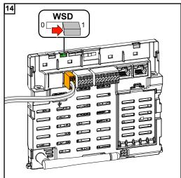
Verifique se o interruptor WSD está na posição 1 e configurar, se necessário (configuração de fábrica: Posição 1).
