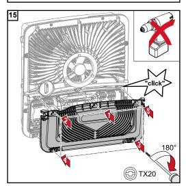
Coloque a tampa na área de conexão. Aperte os 5 parafusos na ordem indicada com uma chave de fenda (TX20) e faça a rotação de 180° para a direita.
