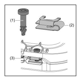
Um sistema de fechamento rápido (3) é usado para montar a tampa da área de conexão e a tampa frontal. O sistema abre e fecha com meia volta (180°) do parafuso com trava de segurança (1) na mola de fechamento rápido (2).
