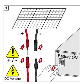
Conecte os cabos do módulo solar (+/-). Ligue a bateria conectada no inversor.
