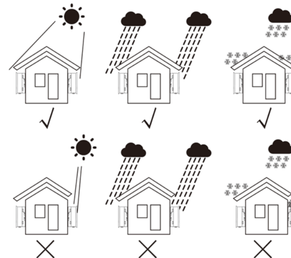
Figura 5.1 Ubicaciones de instalación recomendadas
