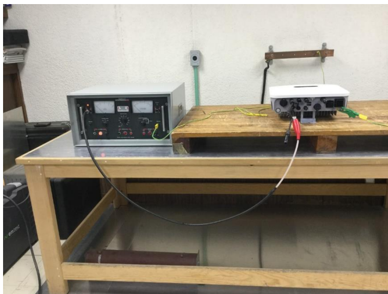
Figura 27. Prueba de capacidad del aislamiento contra sobretensiones.
