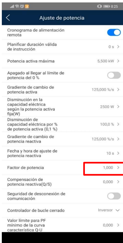
Figura 4. Configuración del factor de potencia en aplicación móvil "FusionSolar".
