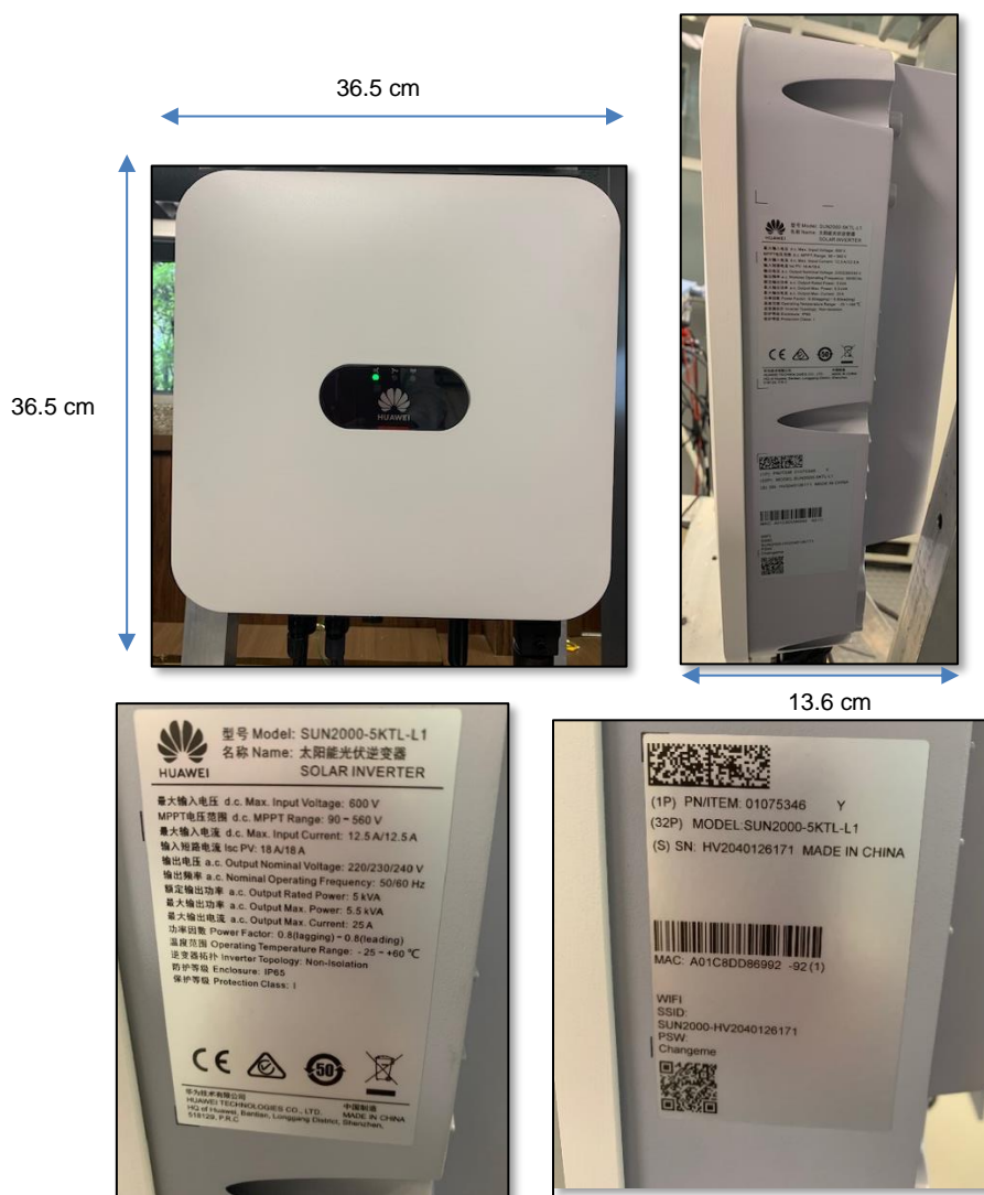
Fotografía 1. Fotografías y datos de placa del inversor.
